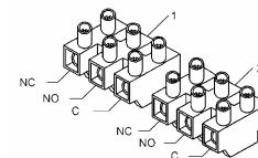
1 = Anschlussklemme Schalter A / Terminal block switch / bornier microrupteur A
